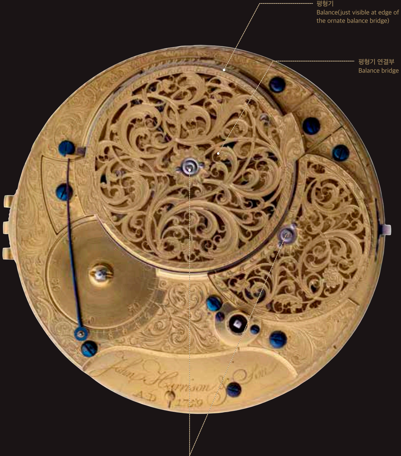
루비와 다이아몬드 베어링 Ruby bearing-holes with diamond endstones
