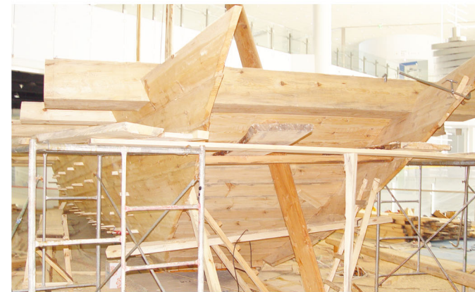
3. 선미, 키 설치
